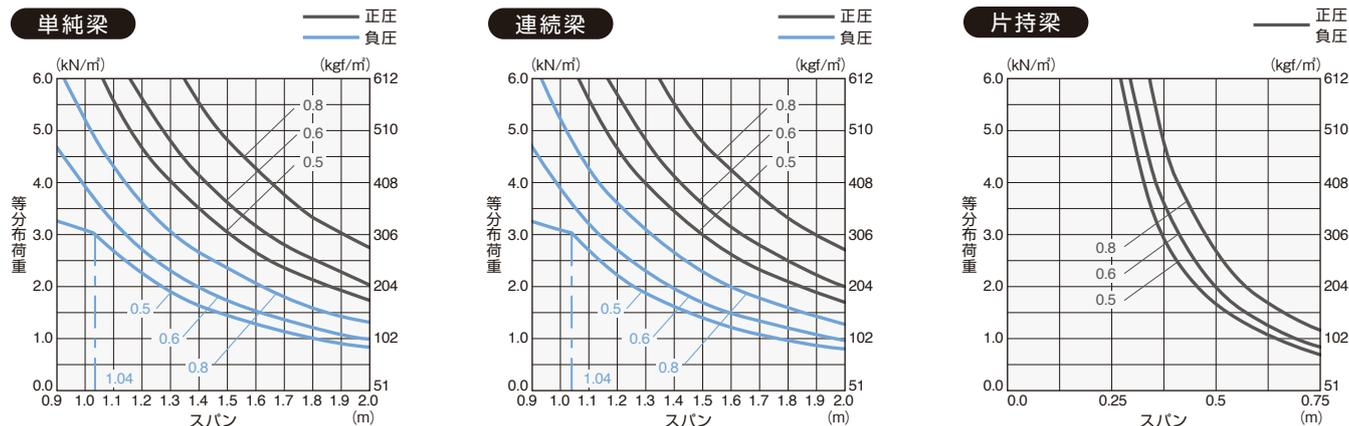
※上記の許容梁間(負圧)は断面性能による計算値と動風圧試験値との小さい方の値を採用しています。多雪地・強風地域でのご使用には設計荷重を十分ご考慮ください。
